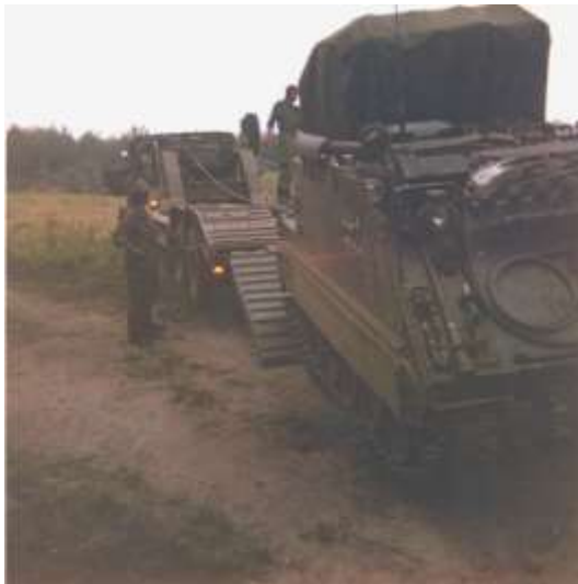
...fast schon Routine das Verladen des GREEN ARCHER.. Wegen des großen Gewichtes in Heck des Panzers wurde er „rückwärts“ auf den Transporter gezogen.
